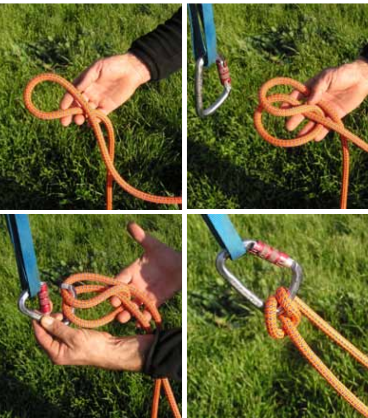
Sequenza di esecuzione del nodo mezzo barcaiolo
