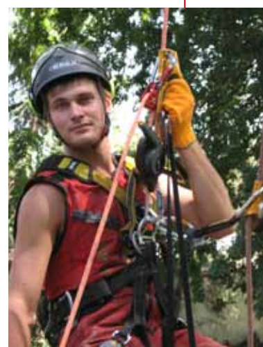
Sequenza di risalita con discensore e maniglia, con carrucola
