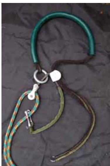
Ancoraggi: falsa forcella regolabile (ropeguide)
