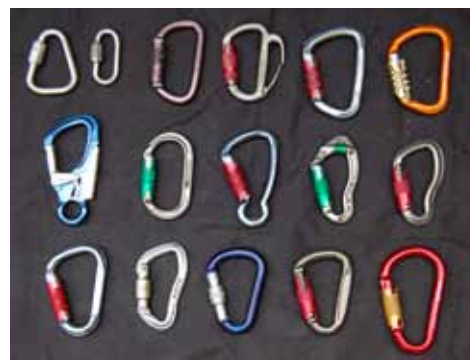
Differenti tipologie di connettori, dimensione e forma variano in relazione agli impieghi di lavoro
