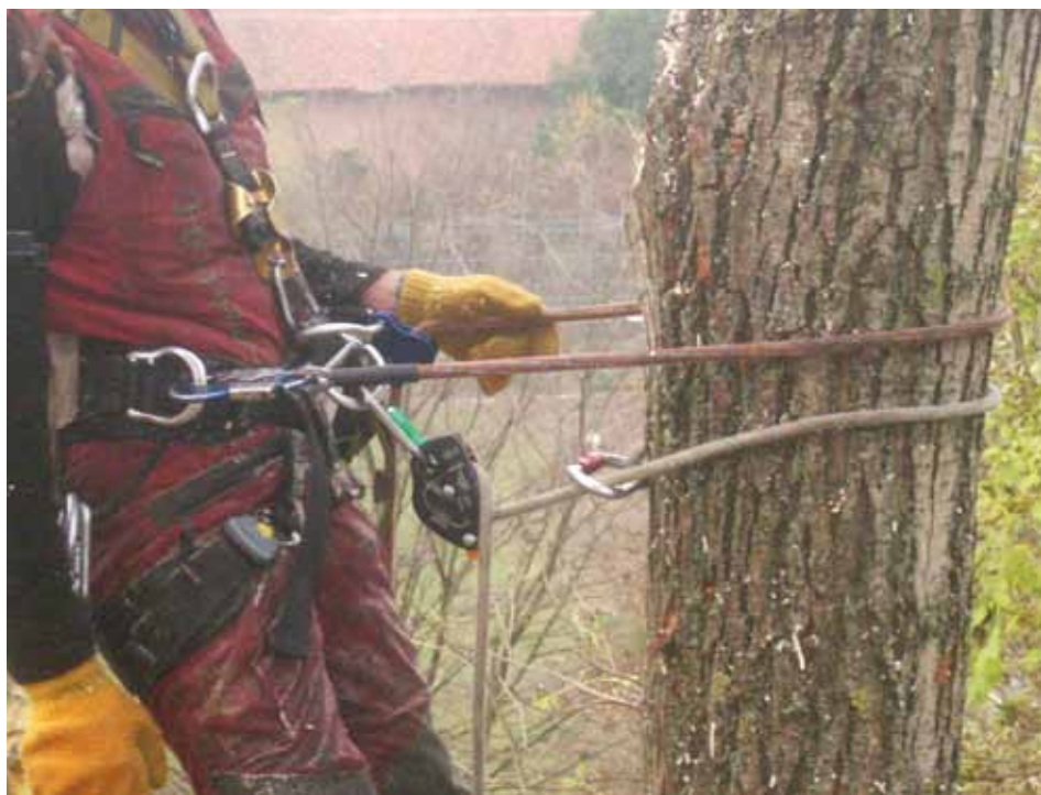
Particolare della longe di posizionamento fissata agli attacchi laterali e la corda di lavoro vincolata all'operatore mediante un discensore
