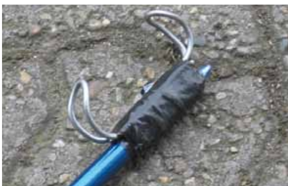
Gancio doppio montato sull'estremità della sonda per effettuare la spinta e il recupero della corda
