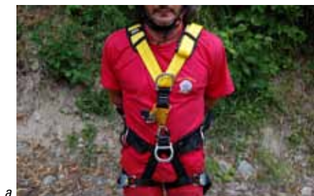
a, imbragatura completa in cui sono evidenti, dal basso verso l'alto, i cosciali, la cintura di posizionamento con attacco centrale (ventrale) e quelli laterali, la bretella con attacco anticaduta anteriore (sternale).
