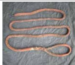
Sling per ancoraggio asolata, a treccia singola
