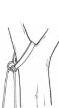
Ancoraggio per corda doppia: corda su falsa forcella. (Soluzione 3)
