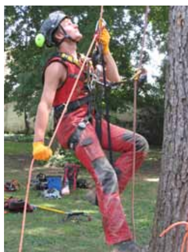
Sequenza di risalita con discensore e maniglia, con carrucola
