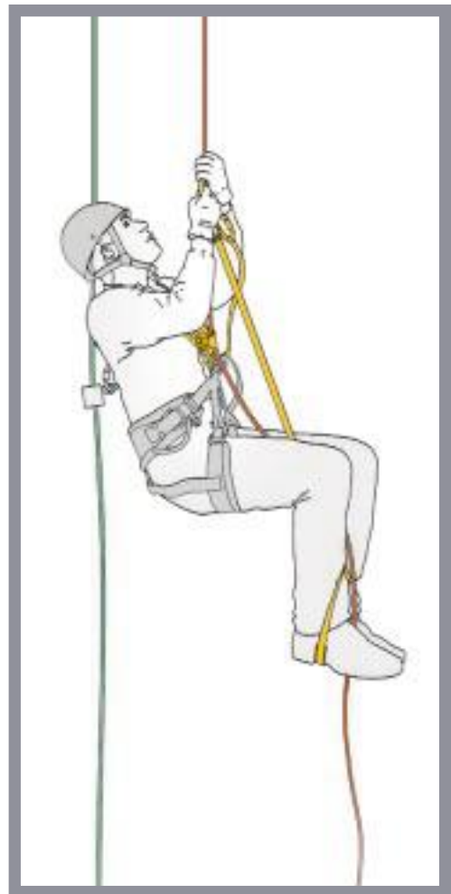
Uso della corda per la risalita senza aiuto della struttura
